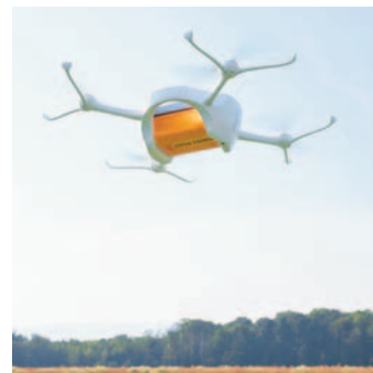
Mit einer Last von einem Kilogramm und einer vollen Batterie schafft eine Drohne heute rund zehn Kilometer.
