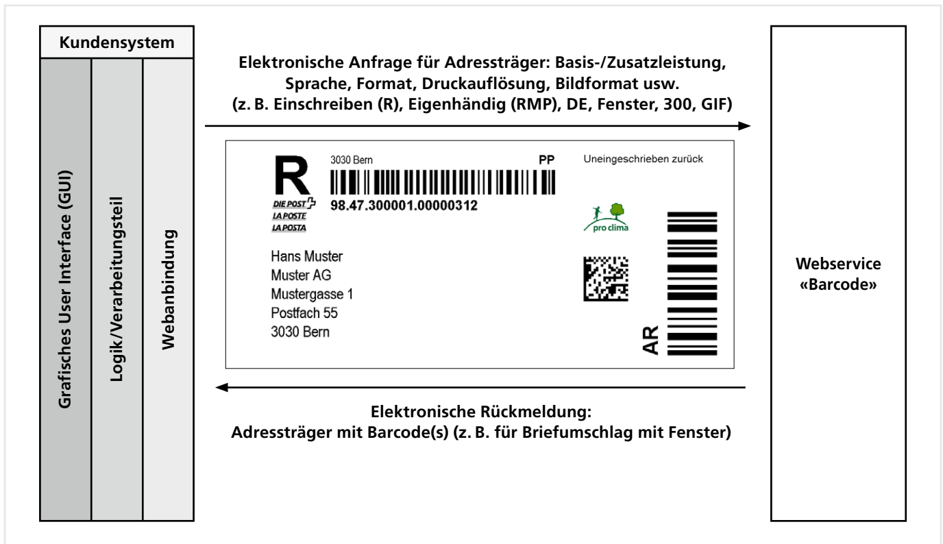
Abbildung 2: Schematische Darstellung zum Aufruf des Webservice «Barcode» > Generiere Adressträger (Dienstleistungsgruppe: Briefsendungen mit Barcode [BMB] In- und Ausland)
